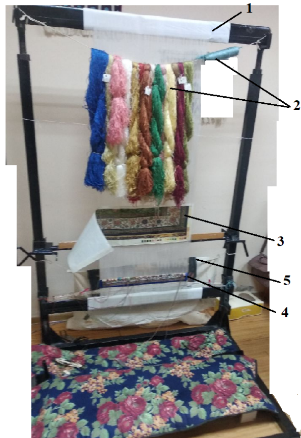
Figure 1. Zamin tanda iplarining taxtlanishi. 1-Zamin tanda ipi, 2- rangli ipak iplari, 4- to'qilayotgan tukli gilamning texnik chizma dasturi, 5-zamin tanda iplarini ajratishni yaxshi ko'rinishi uchun iplar orqa tomoniga o'rnatiladigan qora moslama.
