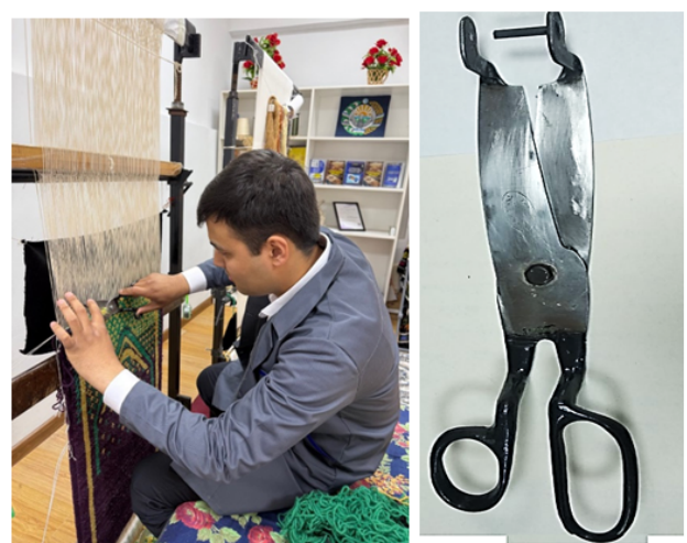
Figure 6. Maxsus qaychi (arqoq tukini kesh uchun qo'llaniladigan maxsus qaychi)
